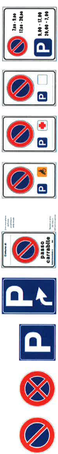
Figura II 74 art. 120 Divieto di sosta Figura II 75 art. 120 Divieto di fermata Figura II 76 art. 120 Parcheggio Figura II 77 art. 120 Preavviso di parcheggio Figura II 78 art. 120 Passeo carrabile Figura II 79/a art. 120 Sosta consentita a particolari categorie Figura II 79/b art. 120 Sosta consentita a particolari categorie Figura II 79/c art. 120 Sosta consentita a particolari categorie Figura II 79/d art. 120 Regolazione flessibile della sosta in centro abitato
