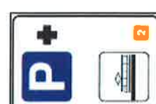
Figura 11 370 art. 136 Parcheggio di scambio con metropolitane od altri servizi extraurbani su rotaia
