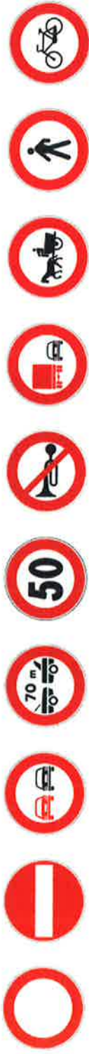
Figura II 46 art. 116 Divieto di transito Figura II 47 art. 116 Senso vietato Figura II 48 art. 116 Divieto di sorpasso Figura II 49 art. 116 Distanziamento minimo obbligatorio di ... metri Figura II 50 art. 116 Limite massimo di velocità ... km/h Figura II 51 art. 116 Divieto di segnalazioni acustiche Figura II 52 art. 117 Divieto di sorpasso per veicoli di massa a pieno carico superiore a 3,5 tonnellate Figura II 53 art. 117 Transito vietato ai veicoli a trazione animale Figura II 54 art. 117 Transito vietato ai Pedoni Figura II 55 art. 117 Transito vietato alle biciclette
